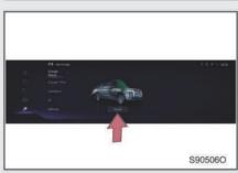
Methode 2: Drücken Sie die Taste für die Abdeckung des Ladeanschlusses in den Ladeeinstellungen des Multimediasystems, und die Abdeckung des Ladeanschlusses wird automatisch geöffnet.
