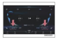
Drücken Sie die Taste [AUTO], die Betriebsanzeige leuchtet auf und der automatische Klimatisierungsmodus wird aktiviert.
