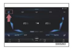
Wenn Sie die Taste für die Lenkradheizung auf dem Bedienfeld der Klimaanlage drücken, leuchtet die Anzeige auf und die Lenkradheizung wird aktiviert. Drücken Sie die Taste erneut, um die Heizfunktion des Lenkrads zu deaktivieren.
