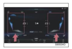
Drücken Sie die Taste für den Luftemissionsmodus, um den Luftauslass zu wählen, und drücken Sie die Taste erneut, um den Luftemissionsmodus zu beenden. Der Luftemissionsmodus kann in Kombination gewählt werden.
