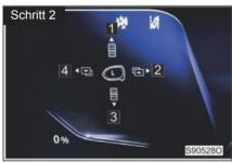
Verwenden Sie das Scrollrad auf der linken Seite des Lenkrads und die linke/rechte Auswahltaste, um den Außenrückspiegel auf der aktuellen Seite einzustellen.
