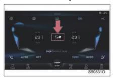
Drehen Sie die Luftmengeneinstellung in der AC-Betriebseinstellung nach oben/unten, um die Luftmenge des AC-Systems zwischen den Stufen 1-7 einzustellen.
